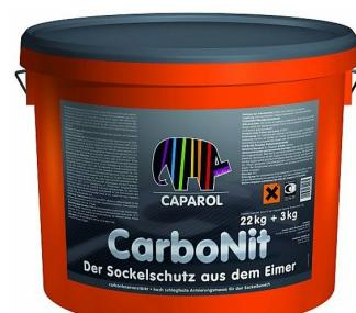
Capatect CarboNit sa nanesie na podklad v šírke pásu odpovedajúcej šírke výstužnej tkaniny zubatým hladidlom (veľkosť zubov sa riadi požadovanou hrúbkou vrstvy, pre hrúbku 5 mm sú vhodné zuby 15x15 mm). Do nanesené vrstvy sa zatlačia pásy výstužnej tkaniny s presahmi aspoň 10 cm. Tkanina sa prekryje vrstvou tmelu a povrch sa uhladí.
